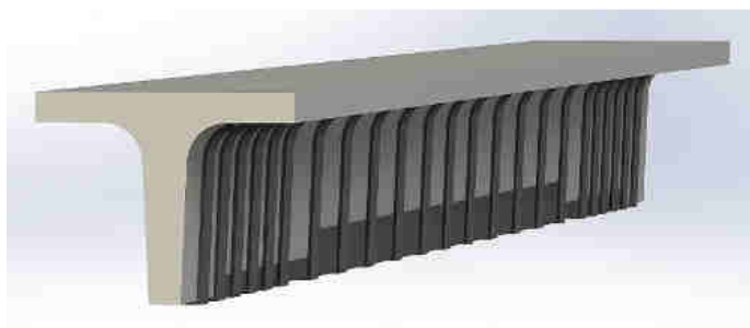
Рис. 3. Третий этап усиления. Наклейка U-образных полос из композитного материала IТЕСWRAР® CF1-011 [7]
