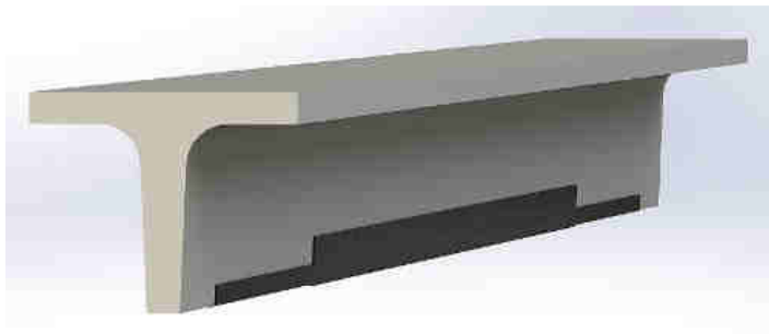
Рис. 2. Второй этап усиления. Наклейка полос ткани из композитного материала IТЕСWRAР® CF1-011 [7]
