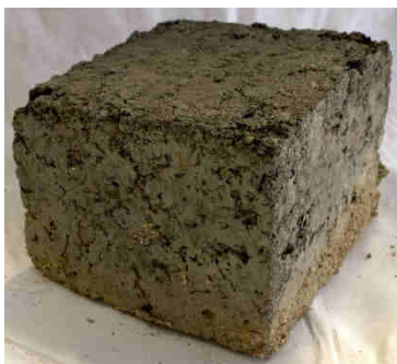
Рис. 2. Образец при оптимальном водоцементном отношении без пластифицирующих добавок
