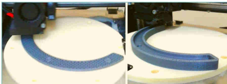
Рис. 3. Стадии печати тестирующей детали на пластине из LasilCast 2
