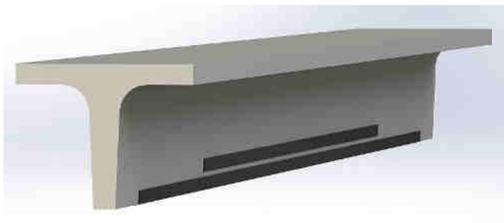
Рис. 1. Первый этап усиления. Наклейка ламелей из композитного материала ITECWRAP® CL1-140 [7]
