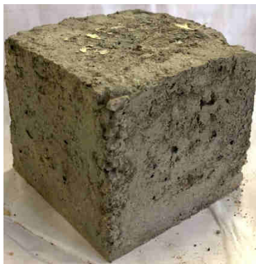
Рис. 3. Образец при использовании пластифицирующей добавки
