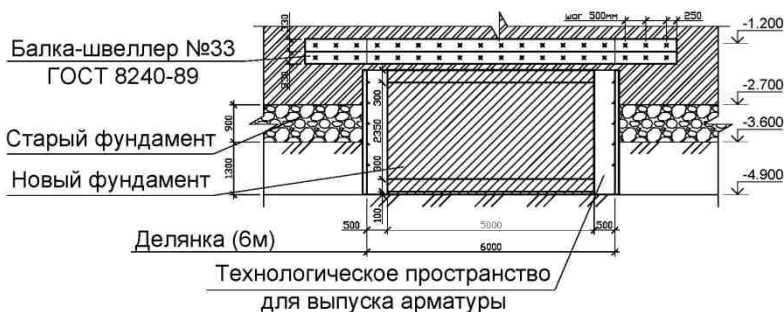
Рис. 2. Участок реконструируемого фундамента
