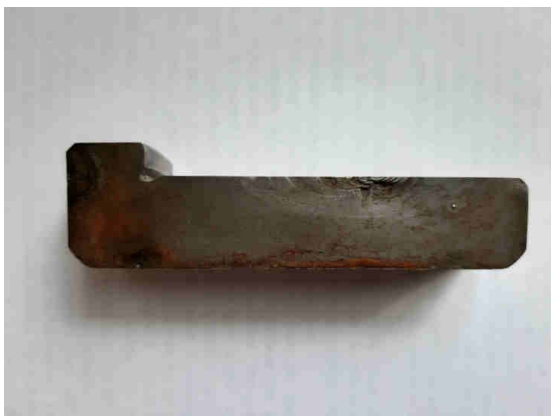
Рис. 2. Усталостное разрушение в изломе кольца подшипника
