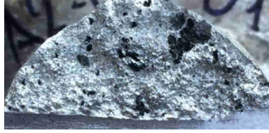
Рис. 1. Излом образца системы Al-10%(Ti+C);
