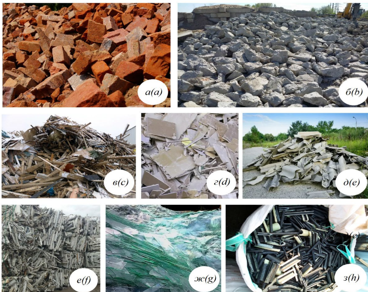
Рис. 2. Виды строительных отходов: a – кирпичный бой; б – бетонный лом; в – отходы древесины; г – гипсовые отходы (гипсокартон); д – асбестоцементные отходы; е – отходы ПВХ; ж – стеклобой; з – отходы шитого полиэтилена
