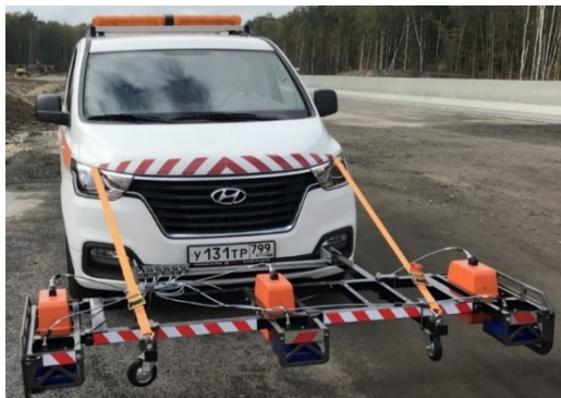
Рис. 3. Мобильная дорожная лаборатория ФАУ «РОСДОРНИИ» с шестиканальным георадарным комплексом
