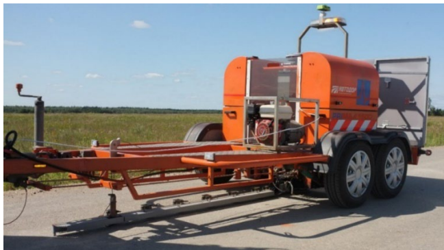
Рис. 4. Установка динамического нагружения FWD Fig.4. FWD dynamic loading machine
